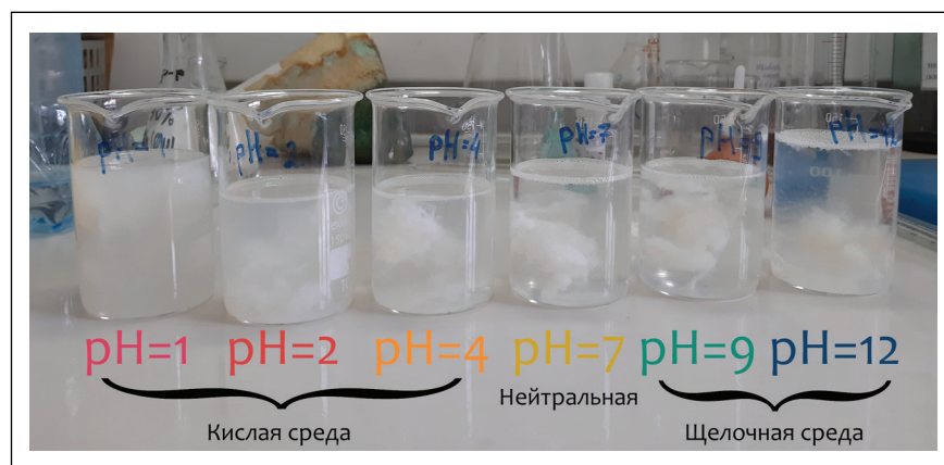
Рис. 8. Изменение структуры флокул ХТЗ-АПАВ при различных уровнях рН-среды
