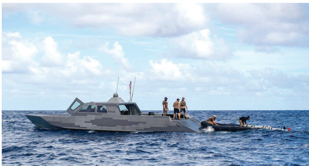
Рис. 2. Проведение испытаний безэкипажного подводного аппарата Mk. 18 Mod. 2, позволяющего вести гидроакустическую и гидрографическую разведку, а также идентификацию подводных угроз в составе специальной лодочной группы ВМС США
