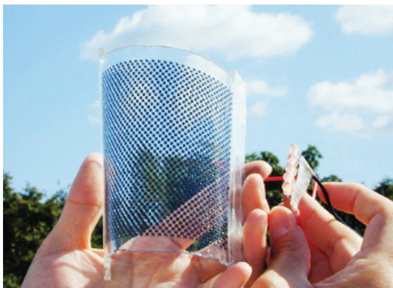
Рис. 2. Элемент солнечной батареи для космоса [9]
