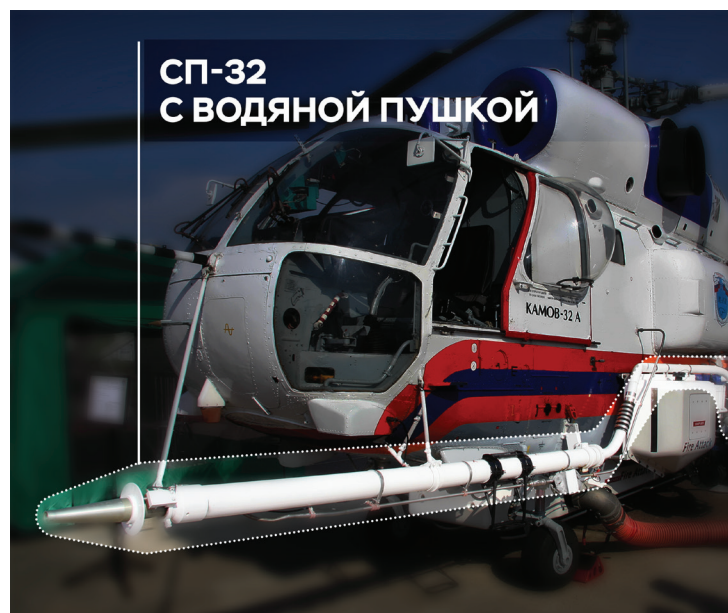
Рис. 6. Система пожаротушения СП-32 с водяной пушкой
