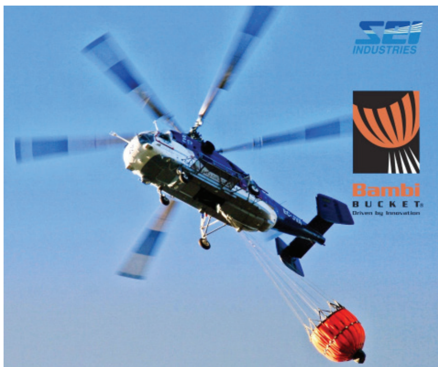
Рис. 3. Вертолетное водосливное устройство Bambi Bucket
