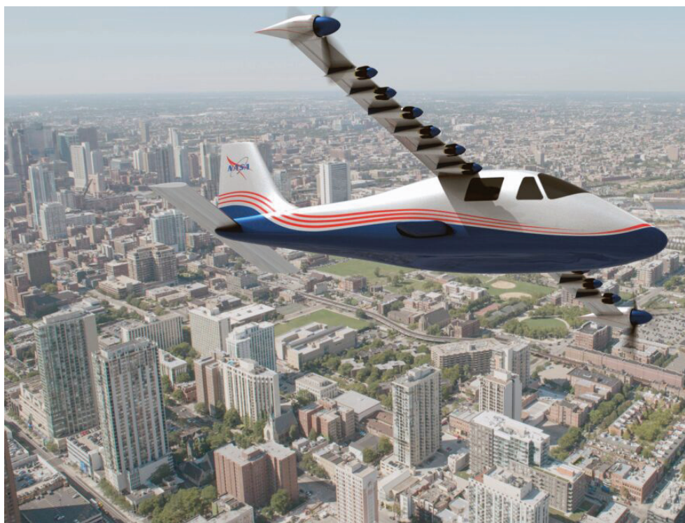
Рис. 2. Концепция полностью электрического пятиместного самолета Х-57 Maxwell (США)
