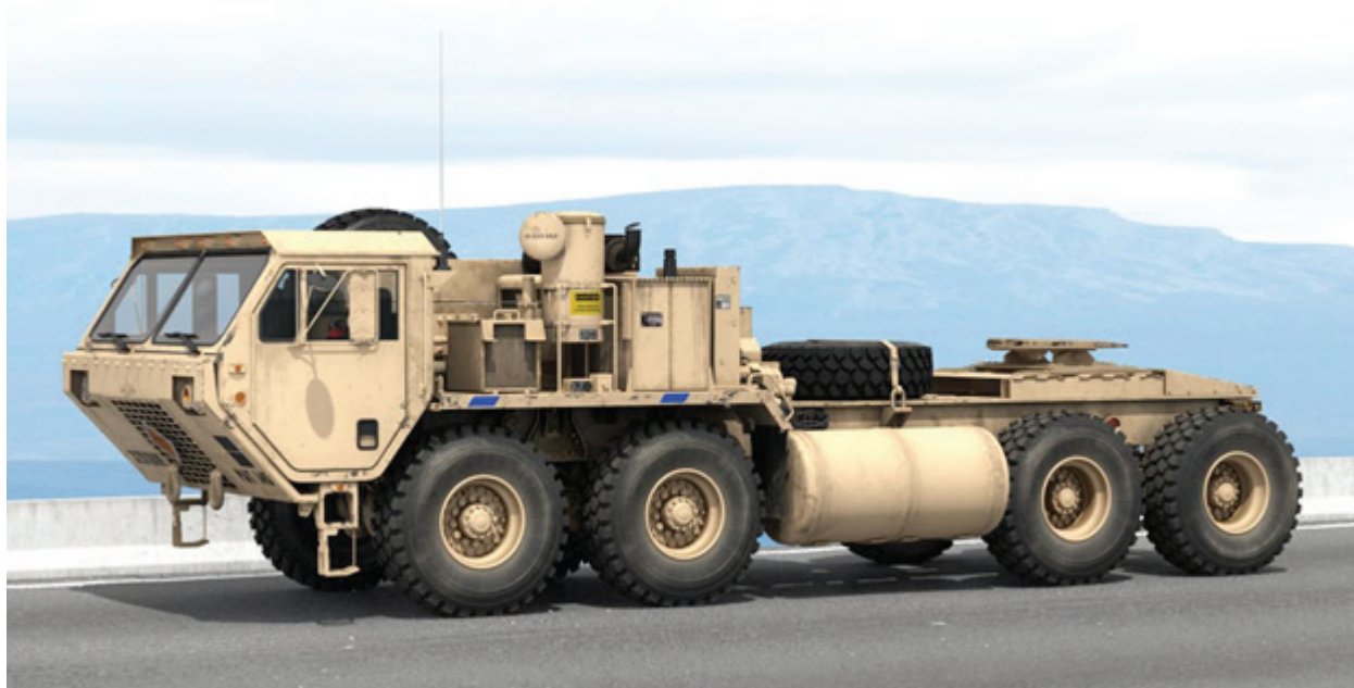
Рис. 4. Тяжелый тактический автомобиль повышенной проходимости НЕМТТ А3 с дизельным генератором
