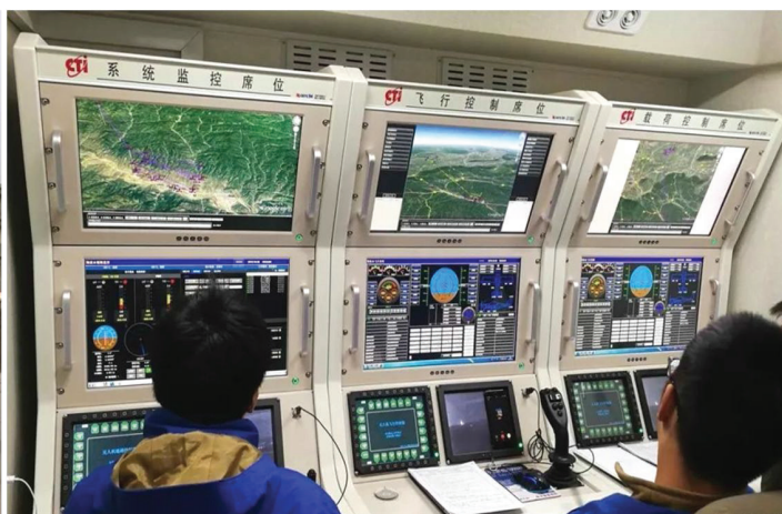
Рис. 6. Рабочие места операторов управления и контроля БЛА АТ-200
