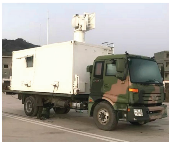
Рис. 5. Мобильная станция управления БЛА АТ-200
