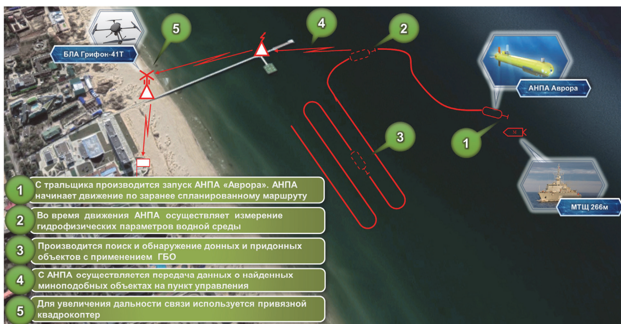
Рис. 2. Первый этап. Построение системы освещения подводной обстановки с использованием робототехнических комплексов
