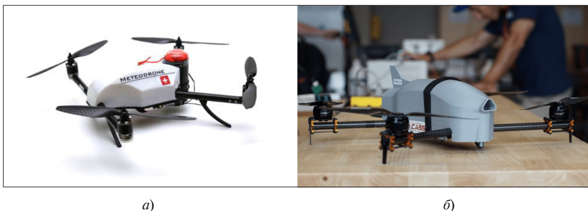
Рис. 3. Фотографии моделей MeteoDrone (а) и CopterSonde (б), разработанных для атмосферных измерений в Швейцарии и США
