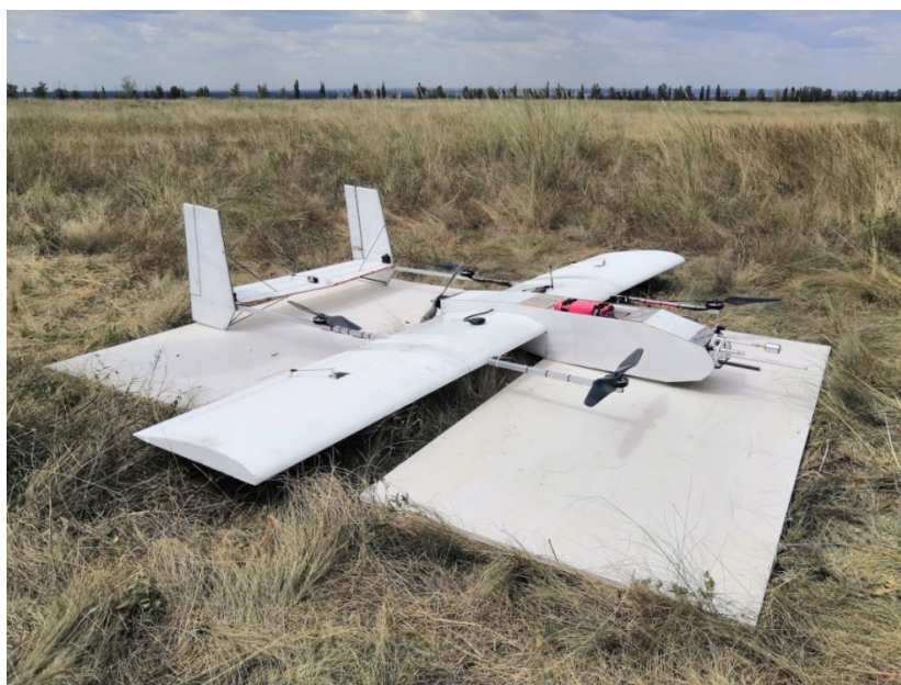
Рис 1. Беспилотный летательный аппарат «Цимлянин» с вертикальными взлетом/посадкой с комплексом полезной нагрузки
