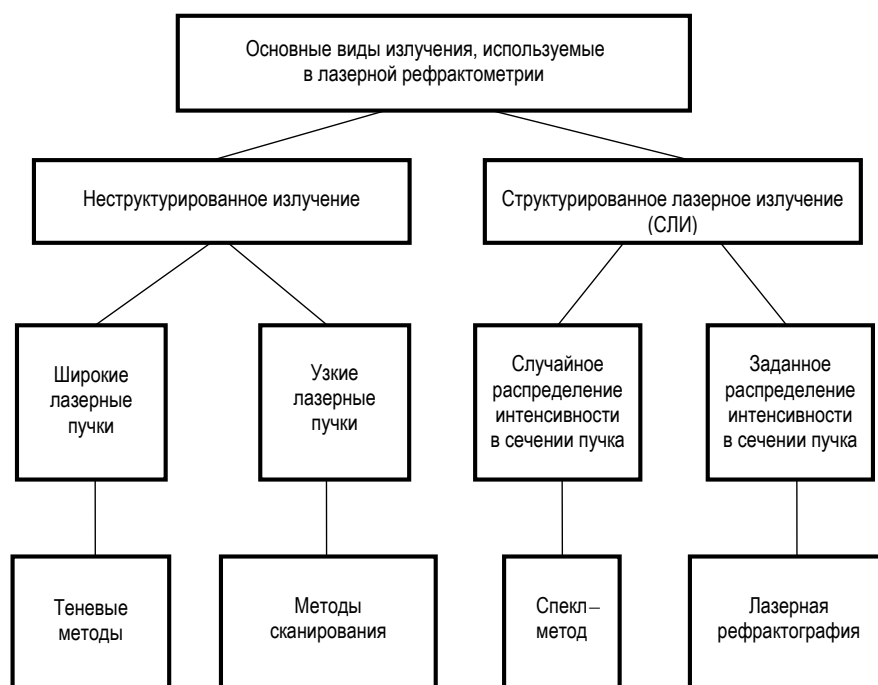
Рис. 2. Классификация методов лазерной рефрактометрии по типу сканирующего излучения
