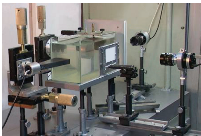
Рис. 8. Экспериментальная установка для наблюдения трехмерных рефрактограмм
