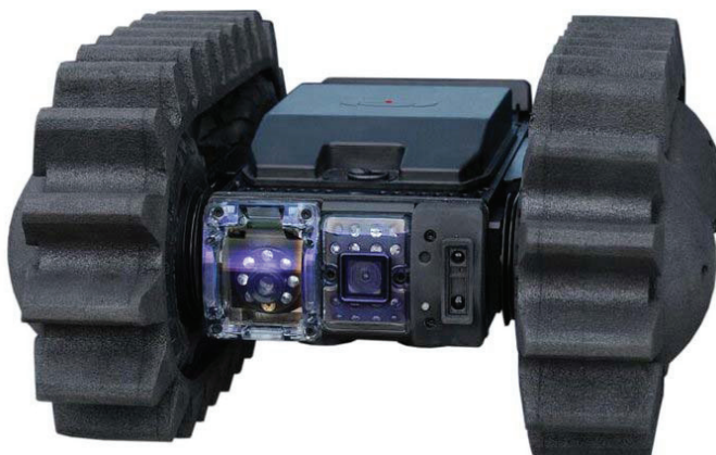
Рис. 7. Забрасываемый робот EyeDrive (США)
