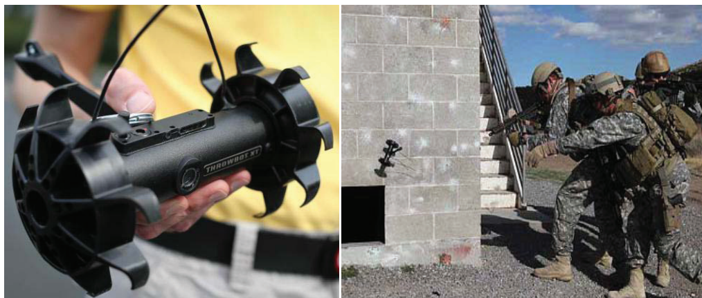
Рис. 4. Забрасываемый робот Throwbot XT (США)
