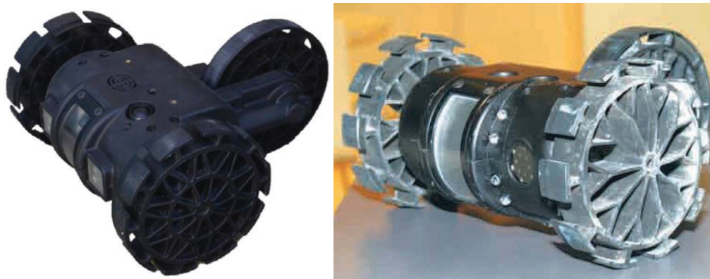
Рис. 6. Забрасываемый робот PocketBot (Швейцария)
