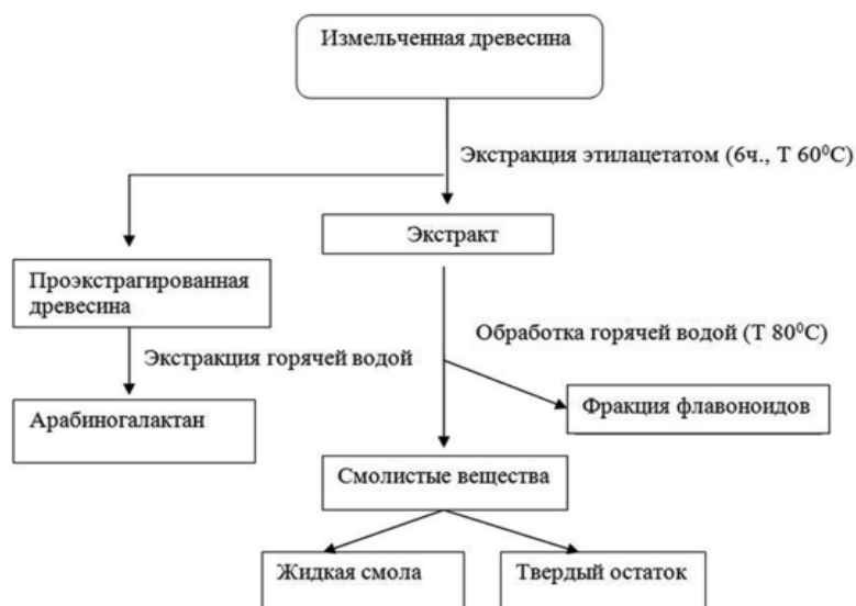
Рис. 1. Схема экстракции древесины лиственницы
