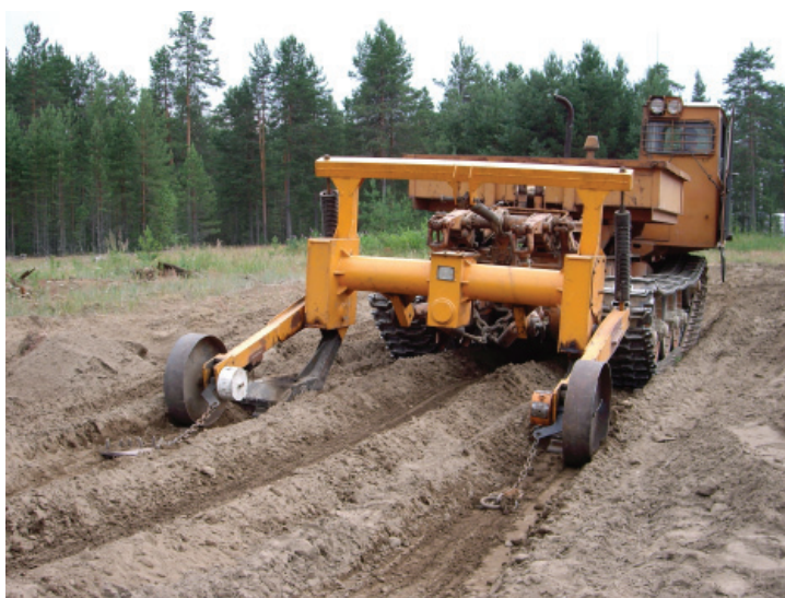
Рис. 2. Сменное приспособление для посева семян Л-2УС
