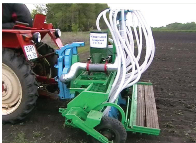
Рис. 2. Общий вид пневматическая сеялка для посева растений фитомелиорантов
