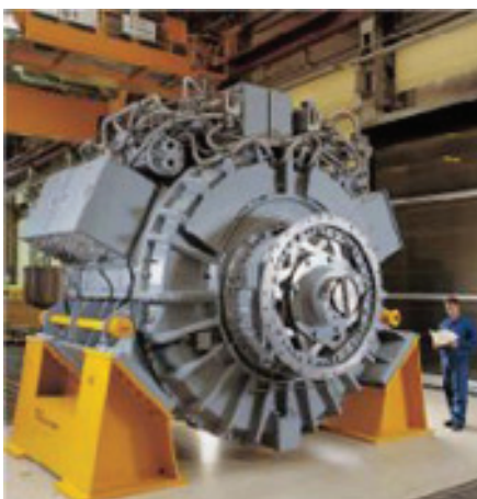
Рис. 3. СЭПМ мощностью 1 МВт марки Permasyn для привода подводных лодок, разработанный компанией Siemens AG, Hamburg, Germany
