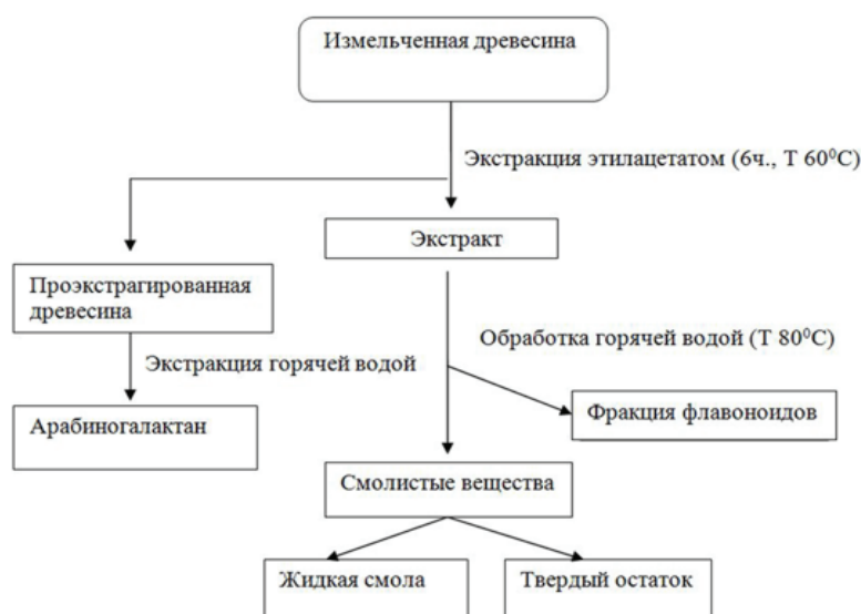
Рис. 1. Схема экстракции древесины лиственницы
