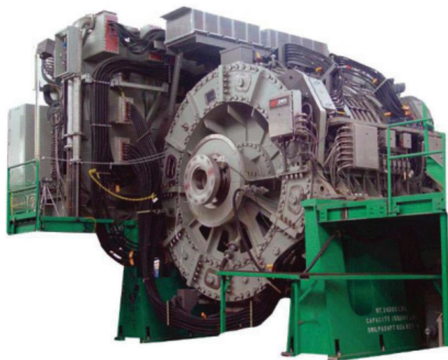
Рис. 2. СЭПМ производства DRS Technologies, NJ, USA (36.5 МВт, 127 об/мин)
