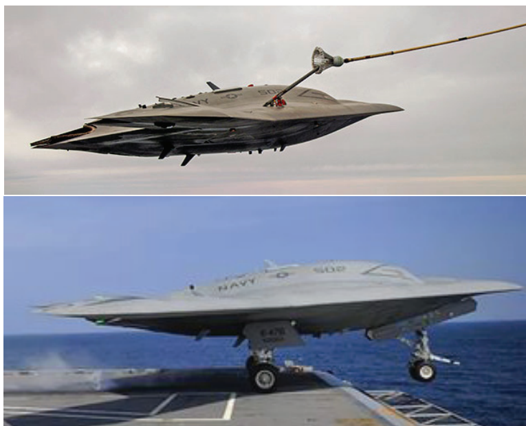
Рис. 4. X-47B в момент дозаправки в воздухе и в момент отрыва от палубы авианосца
