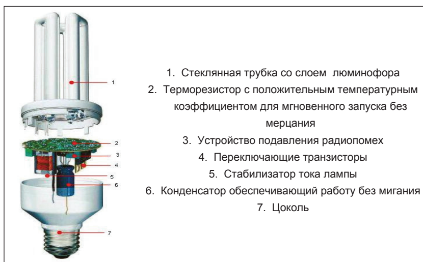
Рис. 1. Устройство КЛЛ
