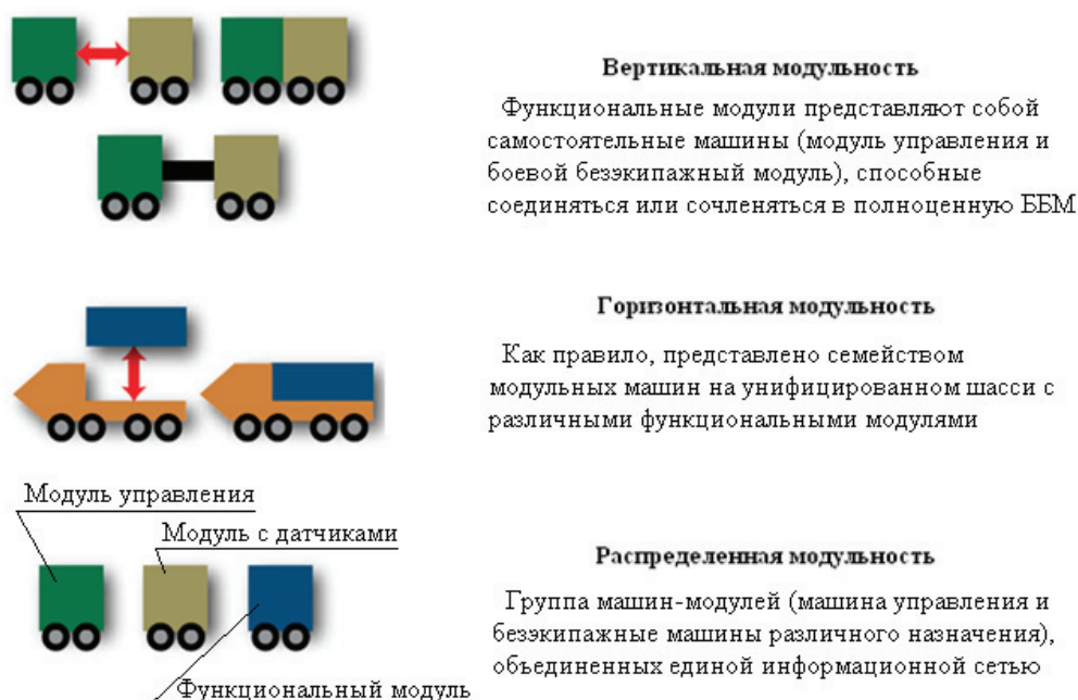
Рис. 1. Схема компоновки различных вариантов модульных машин
