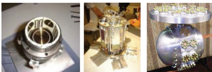
Рис. 11. Сверхпроводящий гравиградиентометр Британской компании ARKeX (разрешение: 1 Этвеш/ \sqrt{\text{Гц}} )
