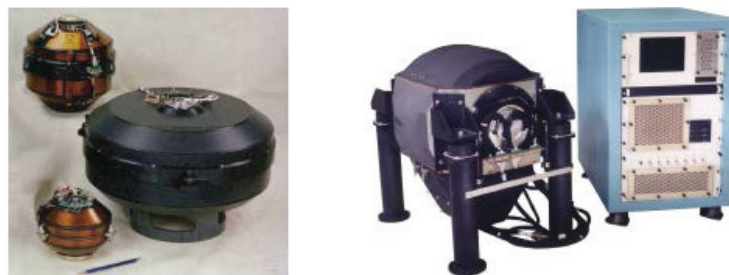
Рис. 10. Гравиградиентометры Lockheed Martin, стабилизированная платформа и система электроники
