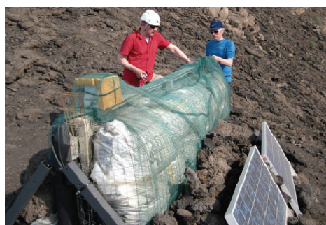
Рис. 13. Защита эмульсионных трековых детекторов от воздействия внешних природных факторов. Исследование состояния вулкана Стромболи (Италия)
