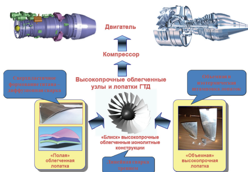
Рис. 1. Лопаточные машины в составе разрабатываемых газотурбинных двигателей (ГТД) с применением новых технологических решений
