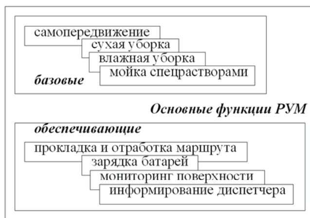
Рис. 3. Основные функции роботизированной уборочной машины (РУМ)
