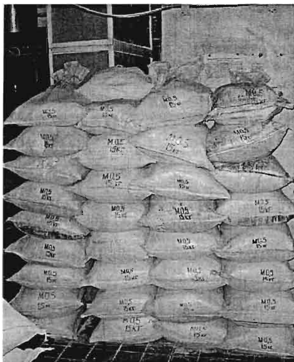
Рис. 2. Готовая к отправке партия абразивных порошков М 0,5 (размер частиц 500 нм)
