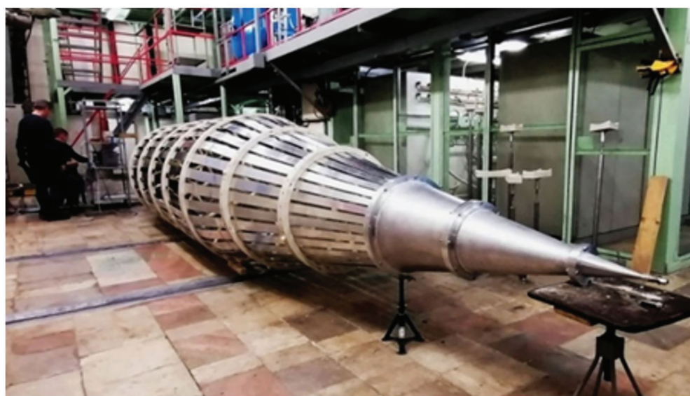
Рис. 10. «Гигантская» коаксиальная линия в помещении стенда «Крот»
