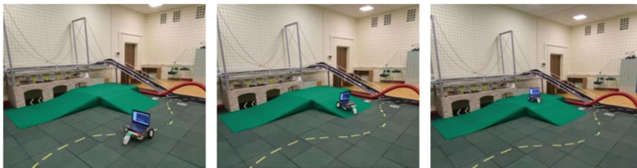
Рис. 2. Процесс заезда робота на платформу по наклонной поверхности
