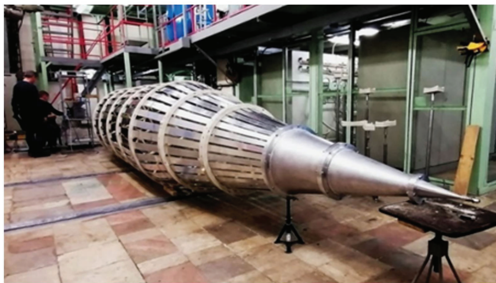
Рис. 10. «Гигантская» коаксиальная линия в помещении стенда «Крот»
