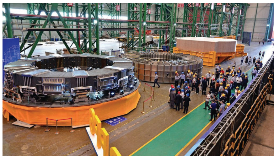
Рис. 6. Сверхпроводниковый электромагнит ИТЭР диаметром 18 м и весом 400 т, а также камера для его пропитки и упаковка для транспортировки магнита [16]
