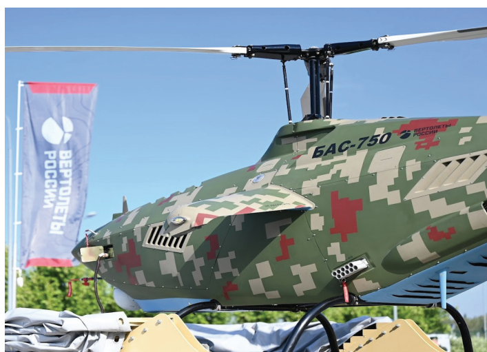
Рис. 3. Тяжелый грузовой беспилотник вертолетного типа БАС-750
