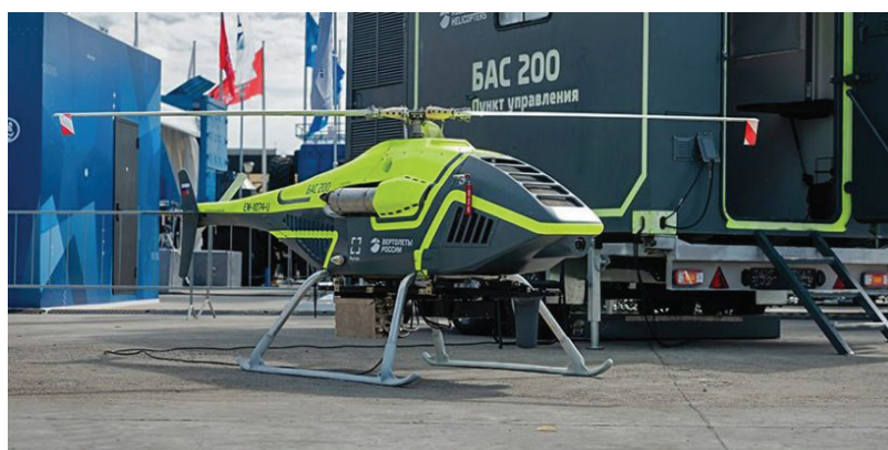
Рис. 1. Многоцелевой беспилотник вертолетного типа БАС-200
