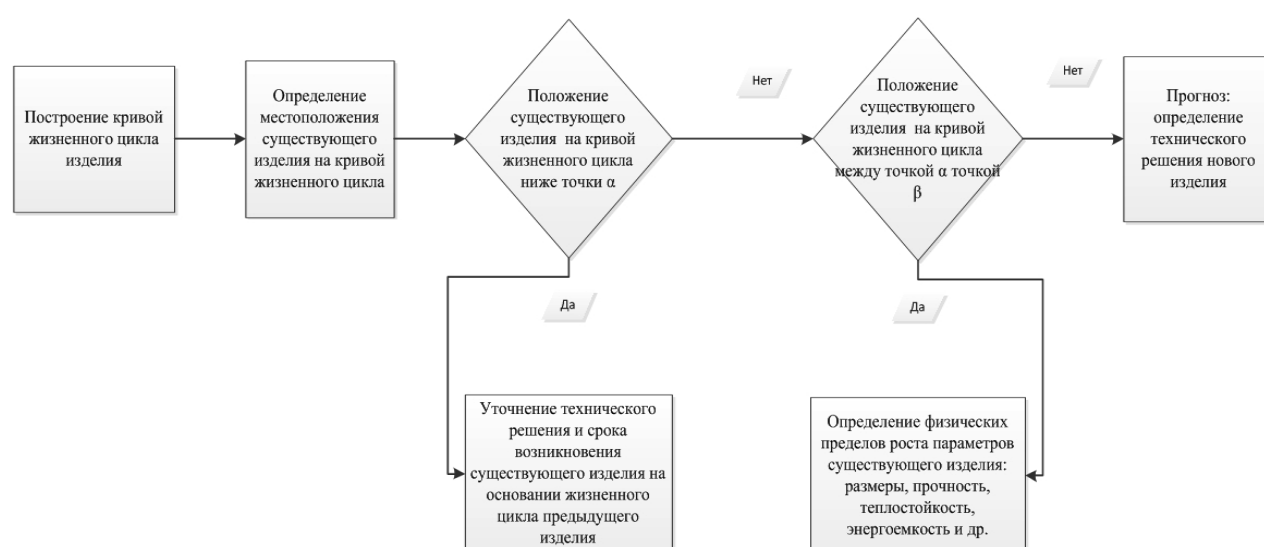
Рис. 4. Алгоритм верификации прогнозного научно-технологического решения эволюционному закону развития технических систем
