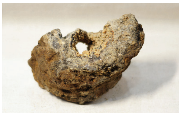
Рис. 6. Фото образца гидротермальной трубы. Гидротермальное поле Гуаймас (Калифорнийский залив, Тихий океан) 27°01'N 111°24'W, глубина 2037 м. Образец получен на подводном обитаемом аппарате (ПОА) «МИР»
