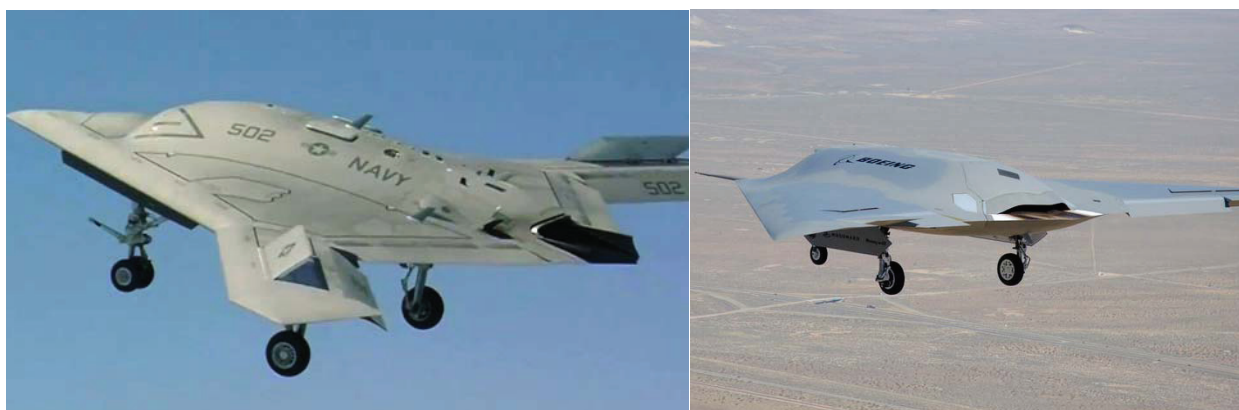
Рис. 9. Реализация нетрадиционных бескилевых аэродинамических схем при создании экспериментальных боевых БЛА X-47B (слева) и «Фантом Рэй» (справа)
