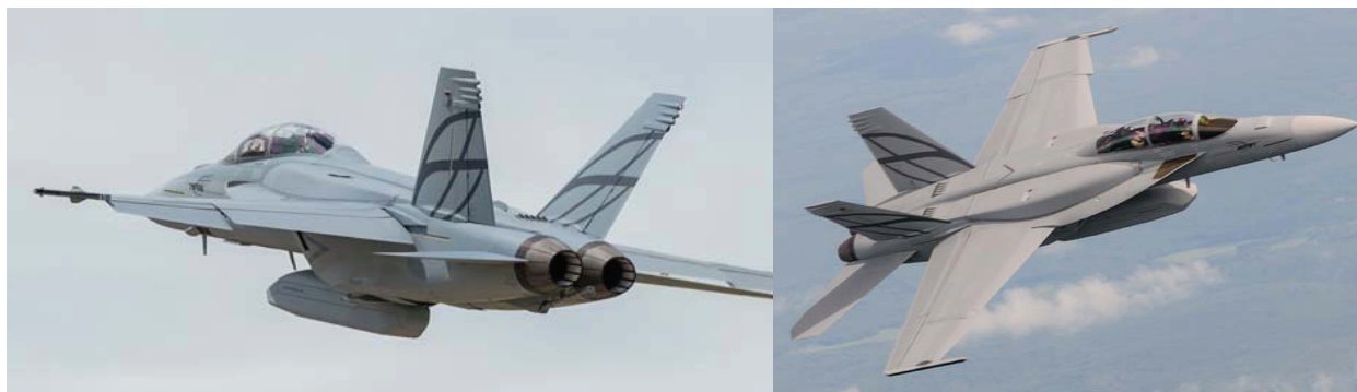
Рис. 7. Многоцелевой истребитель F/A-18E/F «Эдванст Супер Хорнет» с конформными топливными баками и подвесным контейнером для внутреннего размещения оружия
