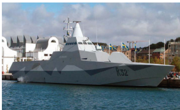
Рис. 1. Многоцелевой корвет пониженной радиолокационной заметности ВМС Швеции типа «Висбю»
