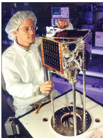
Рис. 2. Малый КА нано-класса «SNAP-1»
