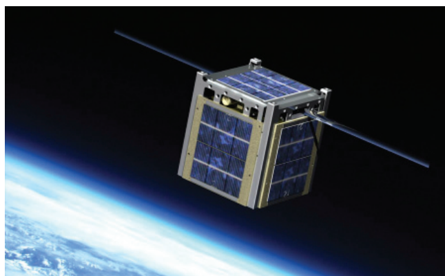
Рис. 3. Малые КА nano-класса «CubeSat»
